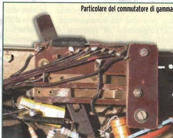
Particolare del commutatore di gamma
